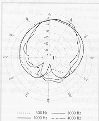
Figure 1 : Courbe polaire d'un appareil à microphones multiples à différentes fréquences. On observe une zone d'atténuation maximale qui, dans ce cas, est essentiellement située à l'arrière de l'utilisateur.
